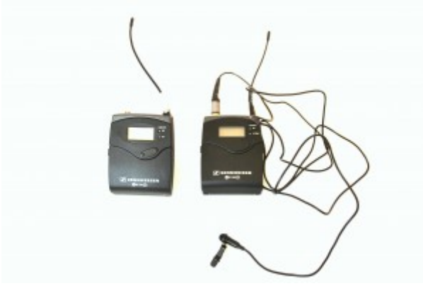
Foto : Transmitter, alıcı ve mikrofon (sol) ve kameraya bağlanan alıcı
