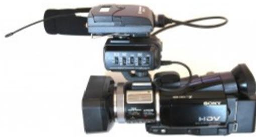
*Sender, Empfänger und Mikrofon (links) und Empfänger an der Kamera befestigt*
