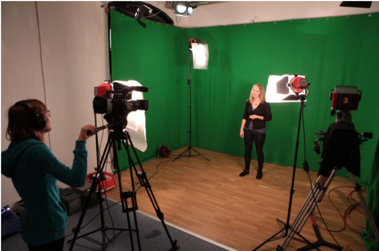
Diese kann auch zu einer 4-Punkt-Ausleuchtung erweitert werden, wenn ein Hintergrund in einem Studio gut ausgeleuchtet werden soll. Auf diese Weise kann man den Hintergrund deutlich von der beleuchteten Person absetzen, was auch die Bedingung für den Einsatz einer [Green- oder Bluebox](#) ist.
